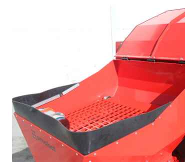
Rejilla para hormigón con electrovibrador -Tapa protección tolva
