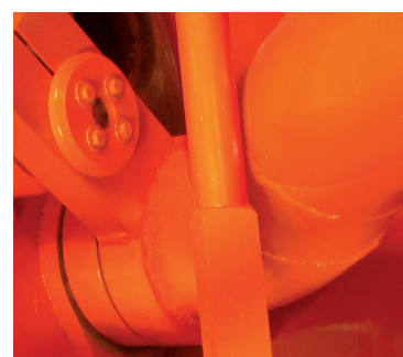
Tolva con válvula "S" con disco y placa de desgaste
