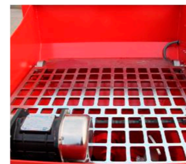
Grille pour béton à vibreur électrique
