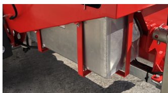
Depósito de combustible en aluminio para evitar corrosión
